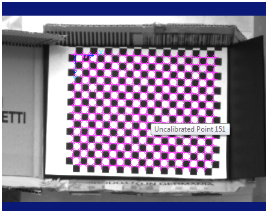
Fig. 26 – La griglia riconosciuta da TS-Vision
