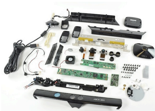
Figura 2: Componenti interni del Kinect
