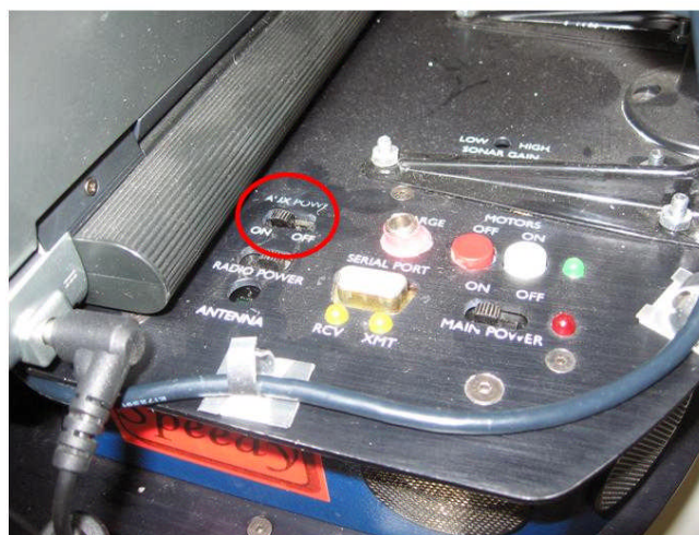
Figura 4.4 – Interruttore per l'alimentazione degli accessori di Speedy
