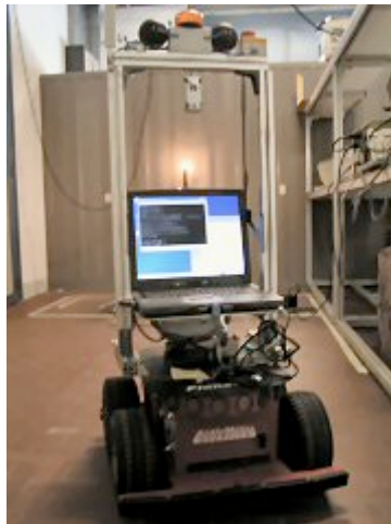
Figura 1 – Ipotesi iniziale: il robot si trova in una posizione arbitraria con i marcatori nel campo visivo della telecamera. Il comportamento determina la direzione di provenienza del robot (in questo caso, da destra).
