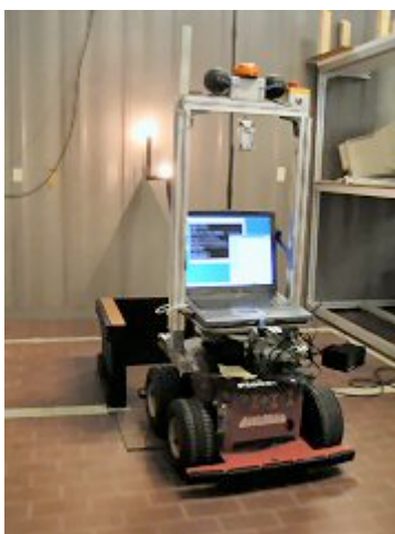
Figura 5 – il robot prosegue in linea retta, mantenendo l’allineamento con l’asse della stazione.
