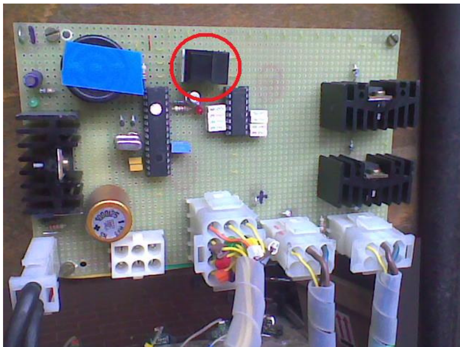
Fig. 7 - Scheda presente sullo schienale, evidenziato il pulsante per il reset.
